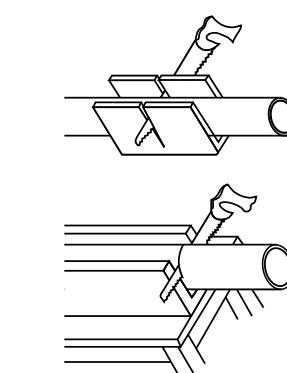
Способ использования деревянного желоба для резки труб
