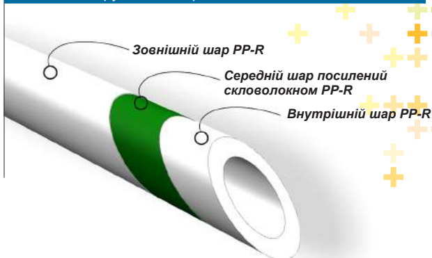
Композитна труба PP-R, армиована скловолокном
